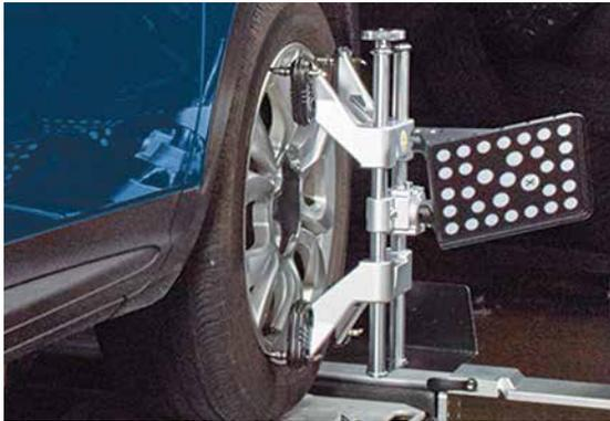
Con un diseño ligero y duradero, las abrazaderas AC700 tienen capacidad para alojar con facilidad neumáticos que varían entre 11" y 22".
