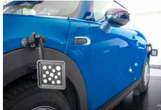
Diga adiós a la introducción manual de datos, acelere las mediciones y aumente la precisión utilizando nuestros objetivos de altura de conducción opcionales y especialmente diseñados.
